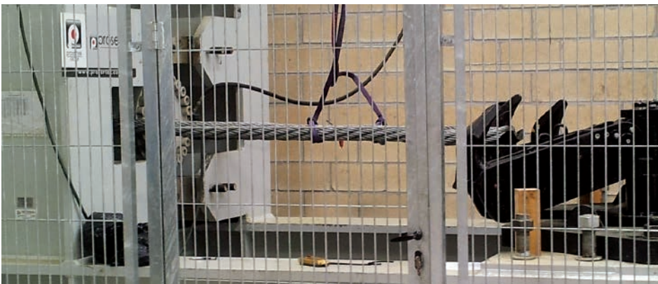
QRH pull testing at Prosertek's facilities Prueba de tiro a GER en instalaciones de Prosertek.
