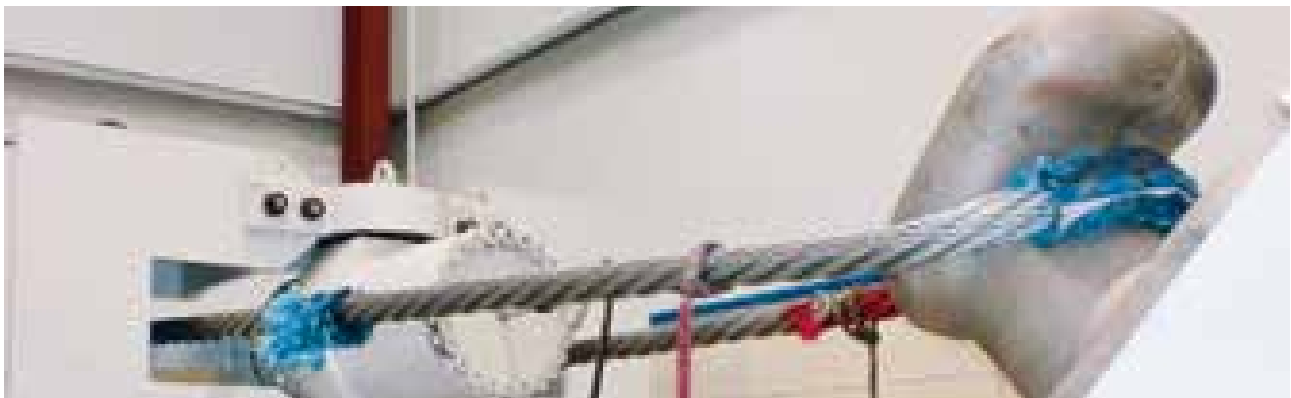
45° load test of Inclined-P type bollard. Bolardo de tipo Inclined-P sometido a prueba de carga con tiro a 45°.
